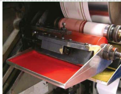
Pembersihan dakwat-dakwat pada silinder percetakan fleksografik
